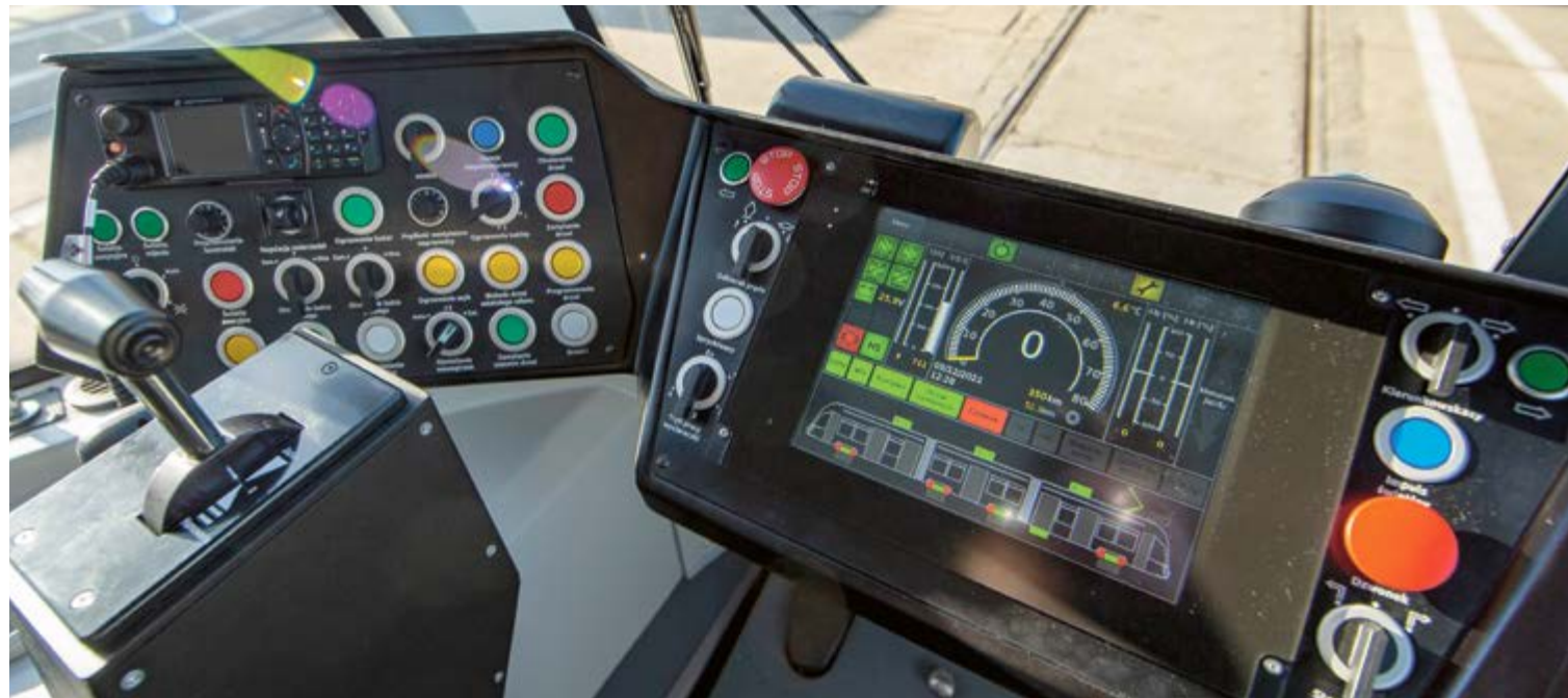
Pulpit w tramwaju Moderus Gamma 2; część przycisków dubluje się w podłokietniku motorniczego
